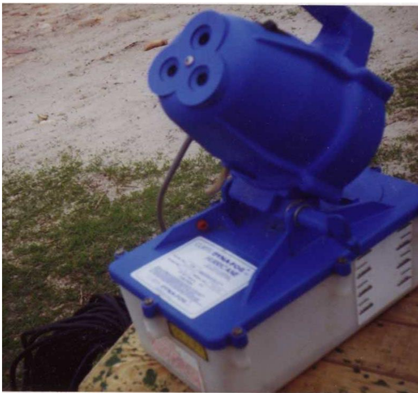
Аерозольний розпилювач із системою живлення від електромережі
